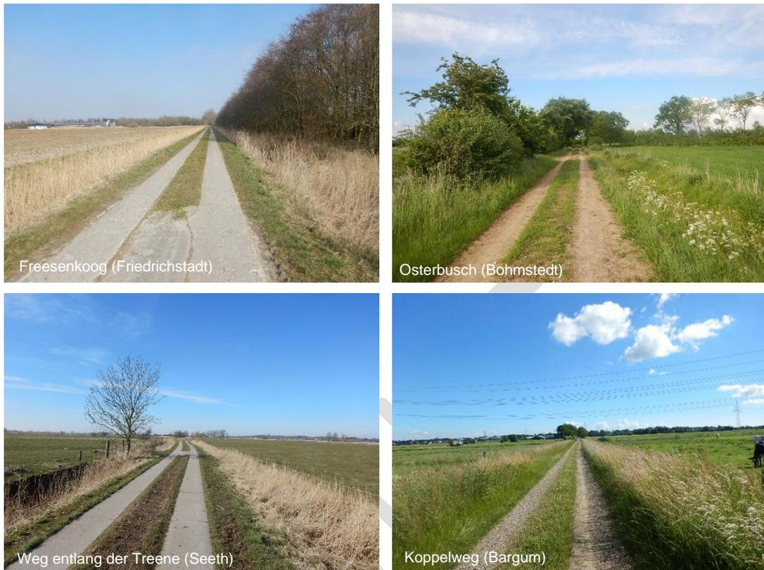
Abb. 7-9: Beispiele für Spurwege als unzureichender Ausbaustandard für den (Alltags)Radverkehr
