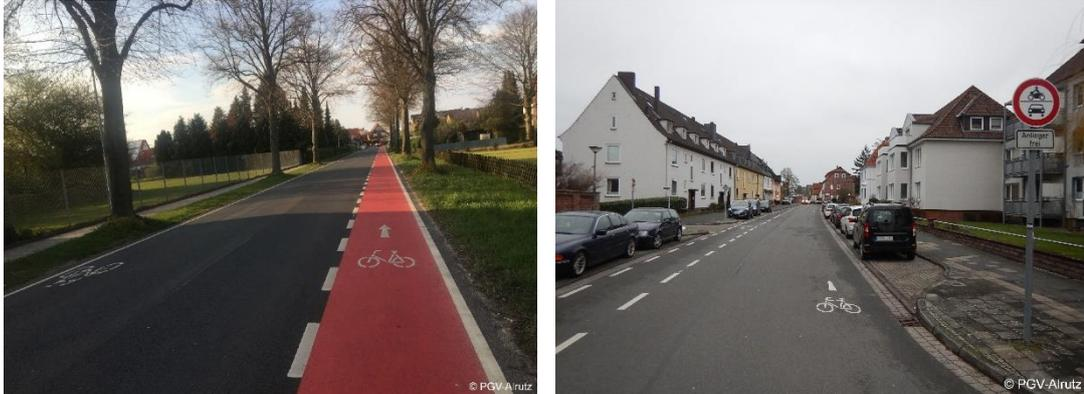
Abb. 7-2: Links: Beispiel für gemeinsamen Einsatz eines Schutzstreifens mit Roteinfärbung und einer gegenüber liegenden Piktogrammreihe auf der Fahrbahn (Harenberg, Region Hannover);
