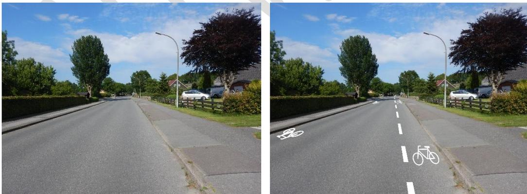
Abb. 7-3: Beispiel für den Einsatz einer Markierungslösung innerhalb einer Ortsdurchfahrt (ggf. mit weiterer richtungstreuer Zulassung des Radverkehrs auf dem Gehweg), Dorfstraße Langenhorn (rechts: Fotomontage)
